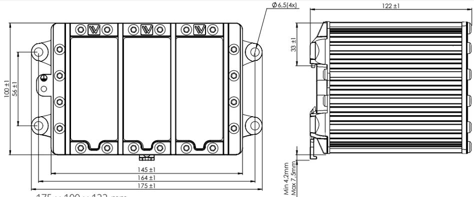
Abmessungen 175 x 100 x 122 mm
