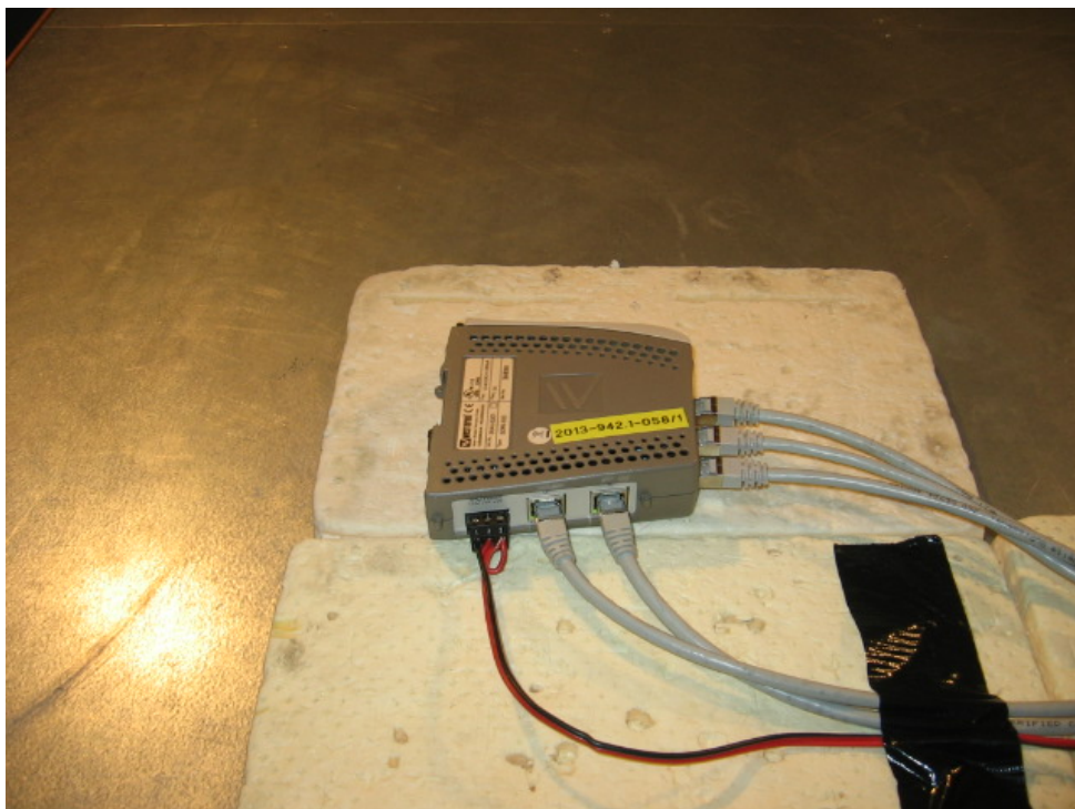
Abbildung 6, Prüfaufbau gestrahlte Störaussendung, Detail Prüfling
