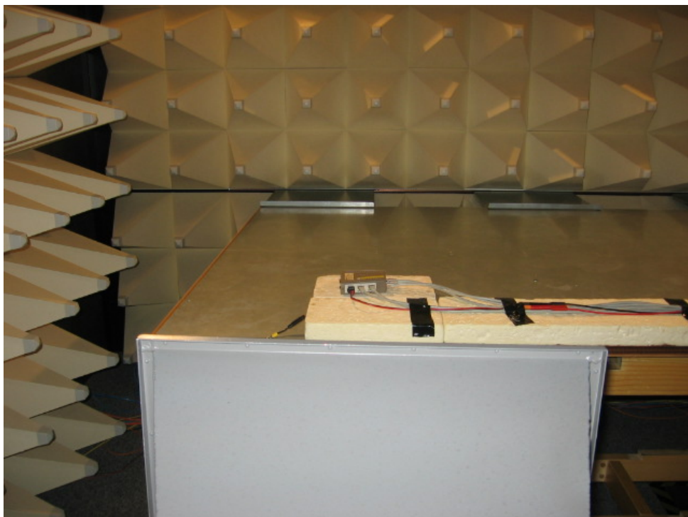
Abbildung 12, Prüfaufbau gestrahlte Störfestigkeit, Antennenmethode > 1 GHz
