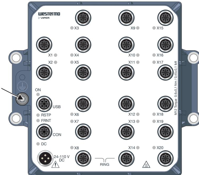
Abbildung 6. Erdungsanschluss
