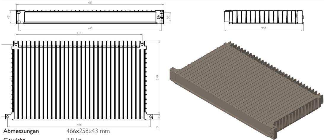
Abmessungen 466x258x43 mm
