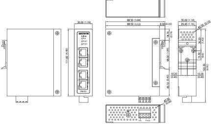
**Dimension W x H x D**  $30 \text{ mm} \times 112 \text{ mm} \times 90 \text{ mm}$
